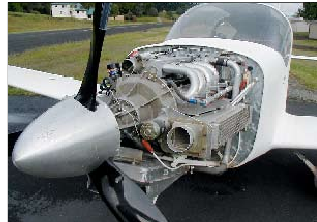
Mazdan 20B-wankelmoottori Kirkpatrick Mark S MSK6 -lentokoneen nokalla. Koneen ensilento oli vuonna 2003. Kuva: Mark Kirkpatrick
