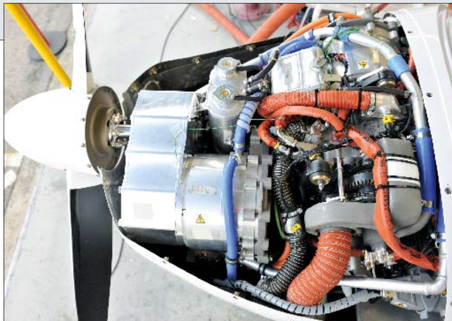
Viime vuoden Le Bourget'n ilmailunäyttelyssä esitelty maailman ensimmäinen sarjatuotanto-hybridilentokone, jossa Diamond HK36 Super Dimonan voimanlähteenä on Siemensin 70 kilowatin sähkömoottori, joka saa sähkövirtansa Austro Enginen pienestä wankelmoottorista. Kuvat: Siemens
